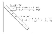
FIGURE 18 - 25 TON LIQUID LINE SOLENOID WIRING
